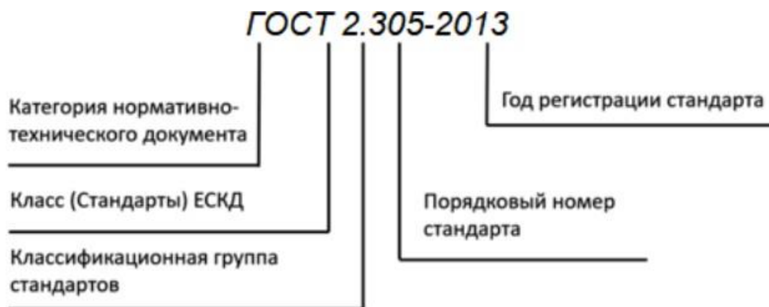
Рисунок 62 – Пример обозначения стандарта ЕСКД ГОСТ 2.305-2008 Единая система конструкторской документации. Изображения – виды, разрезы, сечения
