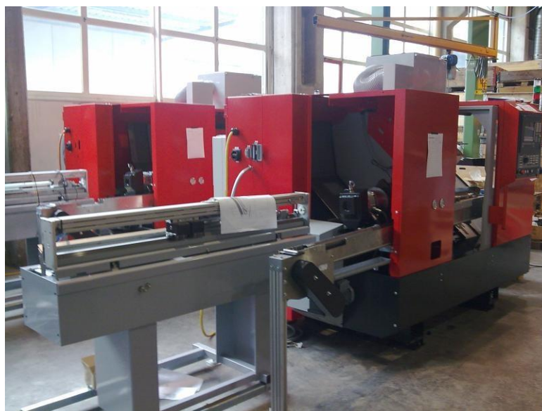
Рис.4. Загрузчик EMCO COMPACT LOAD E65 (R6Z930) к токарному станку EMCOTURN E65TM
