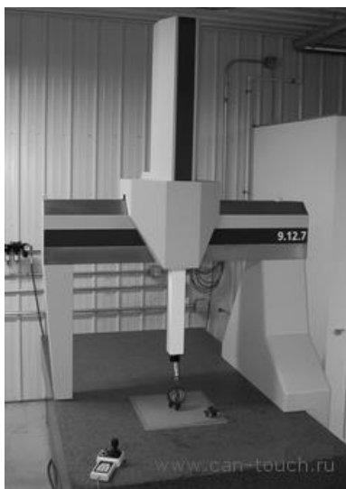
Рисунок 2.2 -Координатно-измерительная машина с двумя фиксированными взаимно перпендикулярными измерительными руками
