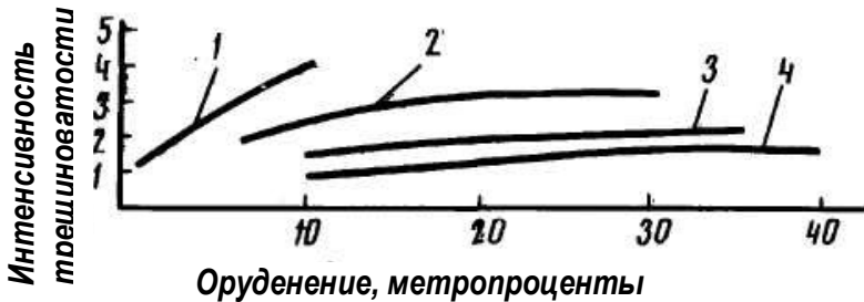
Рис. 3.16. Зависимость интенсивности трещиноватости ( W ) от оруденения ( C ): 1 – залежь «Покро 7а»; 2 – залежь «Кресто – 9»; 3 – залежь «Покро – 7»; 4 – залежь «Покро – 8».
