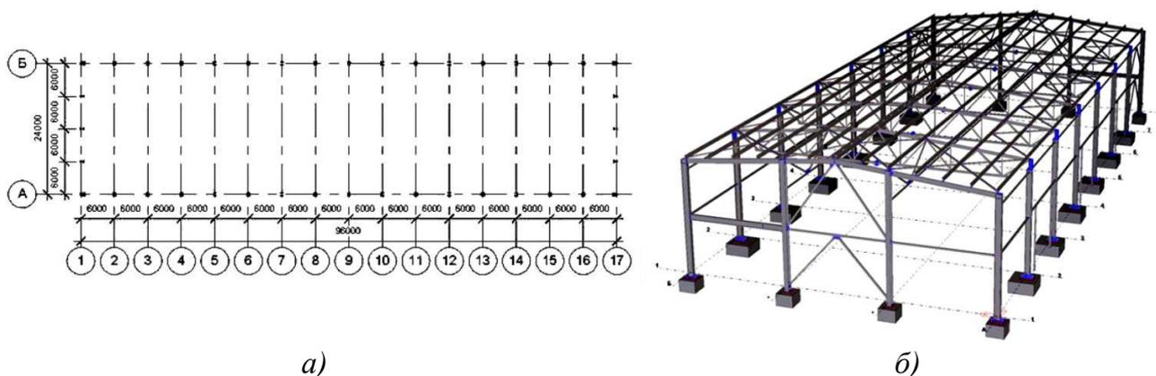
Рисунок 6.1 – Компонка здания производственного корпуса АТП
