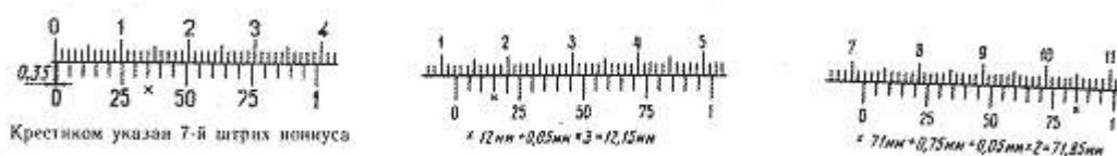
Рис. 6. Отсчет показаний по нониусу с ценой деления 0,05 мм
