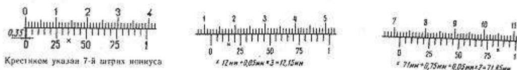
Рис. 6. Отсчет показаний по нониусу с ценой деления 0,05 мм
